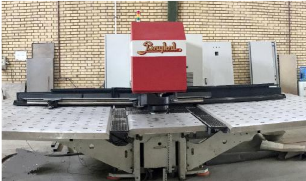
تصویر ۱- دستگاه پانچ CNC با ظرفیت ۳۰ تن
