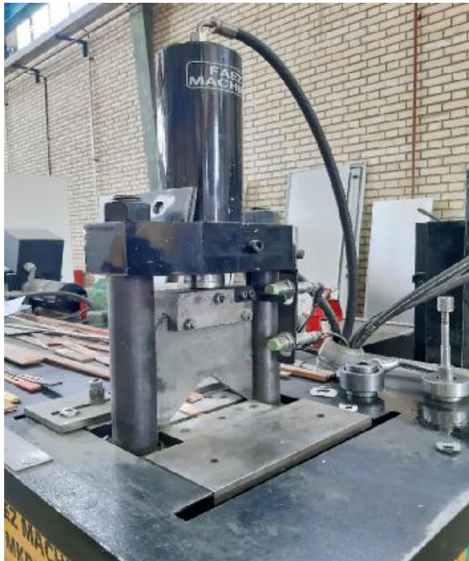
تصویر ۵- دستگاه چهار کاره کامل جهت برش و خم و سوراخکاری شمش مسی
