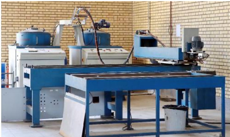
تصویر ۶- ماشین تزریق فوم درب تابلو
