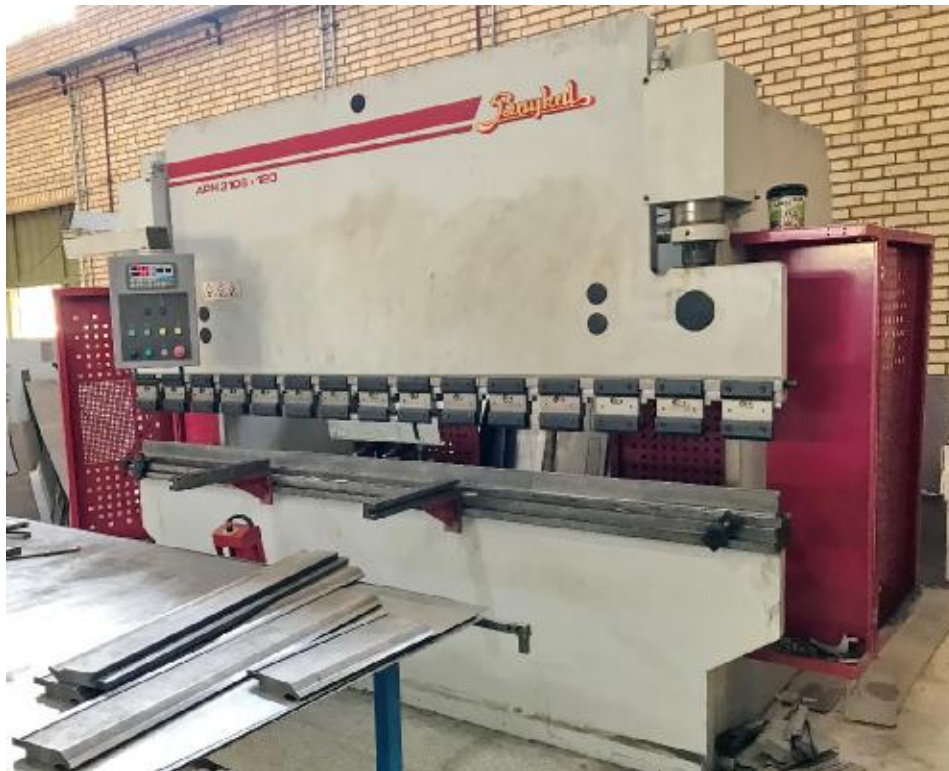
تصویر ۲- دستگاه پرس برک NC با ظرفیت ۱۲۰ تن
